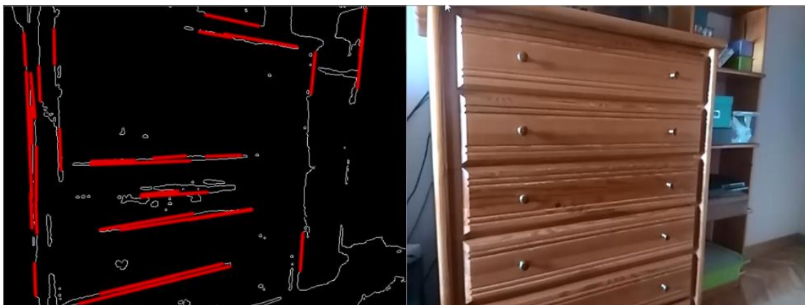
Fig. 4.6 Primer ejemplo de Imagen en la cual se detectaron pocas líneas y bordes del entorno
