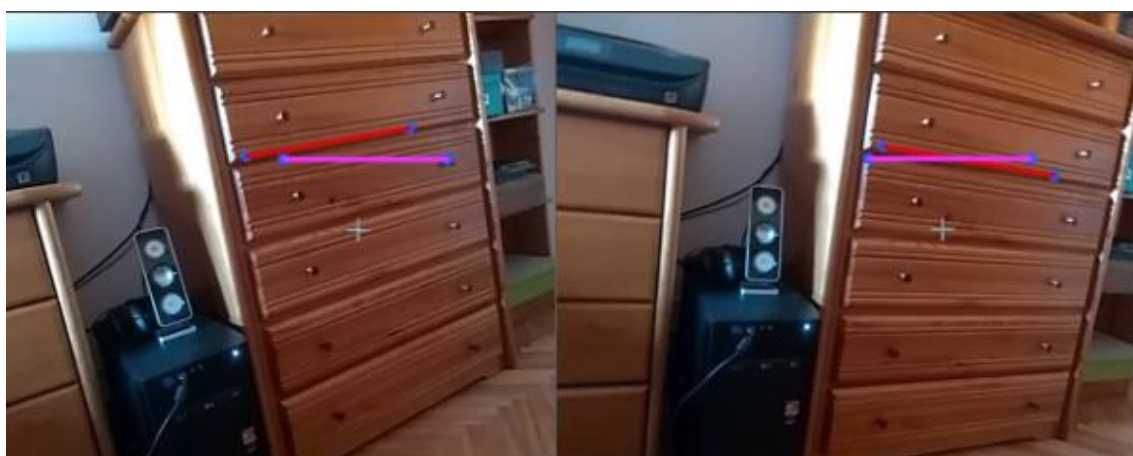
Fig. 4.5 Imagen tras realizar dos desplazamientos diferentes, en ambos la línea roja mantiene en la posición de referencia, mientras que la rosa se mueve con la cámara.
