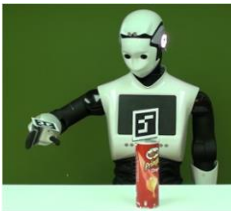
Fig. 2.3 Posición inicial, el robot humanoide gracias al patrón ArUco conoce la posición de su mano y también del objeto a coger.
