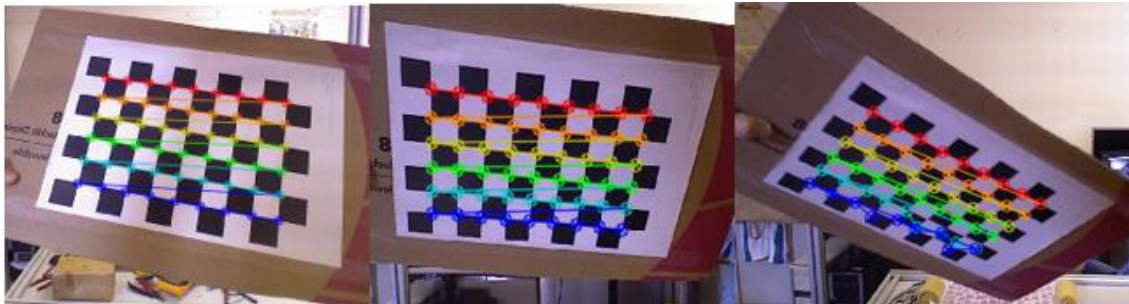
Fig. 5.7 Resultados de “FindChessboardCorners” para tres orientaciones diferentes
