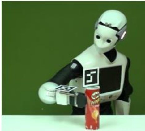
Fig. 2.4 Posición final, una vez se ha acercado la mano al objeto con la orientación adecuada para cogerlo
