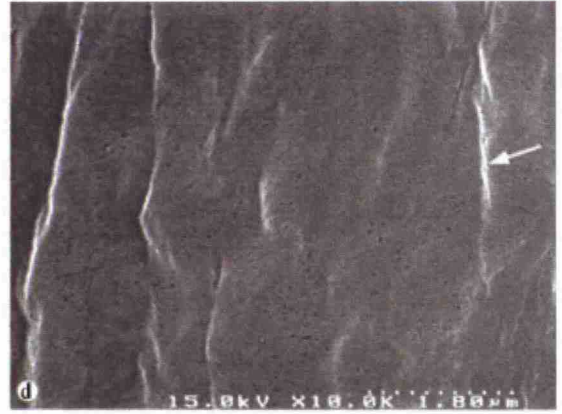
Kuva 3. FE-SEM-kuvat a) korkean (22 %) hemiselluloosapitoisuuden ja d) matalan (10 %) hemiselluloosapitoisuuden havupuukuitujen rakenteesta. Nuolet osoittavat kylmäkuivauksesta aiheutuneen pituussuuntaissupistuman aiheuttamaa poimua. 9
