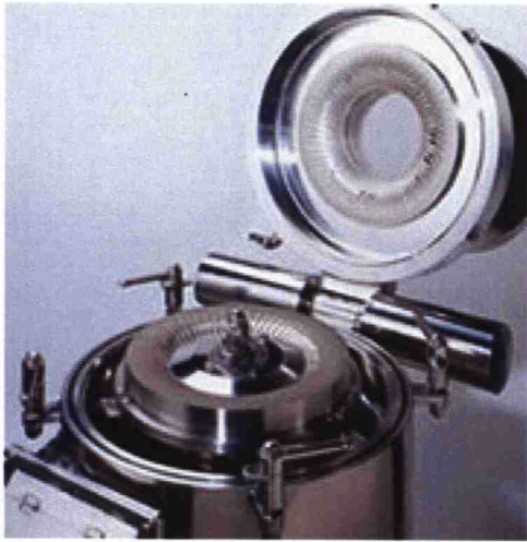
Kuva 8. Masuko Sangyo Co, Ltd:n Supermasscolloider-laite avattuna 27 .
