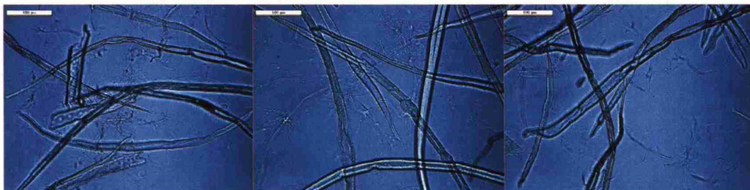
Kuva 12. Valomikroskooppikuvat yhden kerran Masuko-jauhetuista massoista (vasemmalta oikealle): valkaisematon, happidelignifioitu ja täysvalkaistunut massa.
