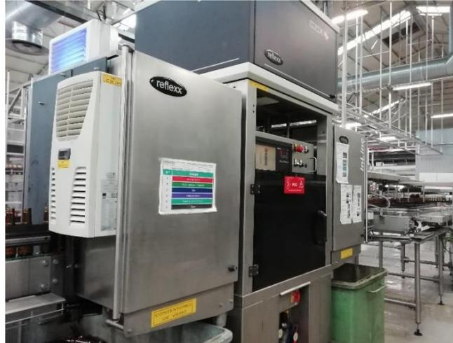
*Figura 23: Imagem ilustrativa do inspetor de garrafas vazias utilizado na linha 2.*
