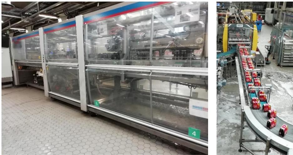
**Figura 27:** *Imagens ilustrativas dos equipamentos de embalagem secundário utilizados na linha 2.*
