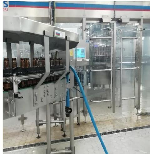
*Figura 24: Imagem da enchedora e capsuladora utilizadas na linha 2.*
