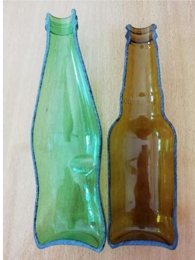
**Figura 30:** Imagem representativa das garrafas P25 e SB20 cortadas transversalmente, de forma a evidenciar o perfil de espessuras das mesmas.
