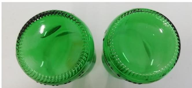
**Figura 43:** Imagem representativa das zonas de recartilha das garrafas P25 aligeiradas da primeira produção (à direita) e da segunda produção (à esquerda).
