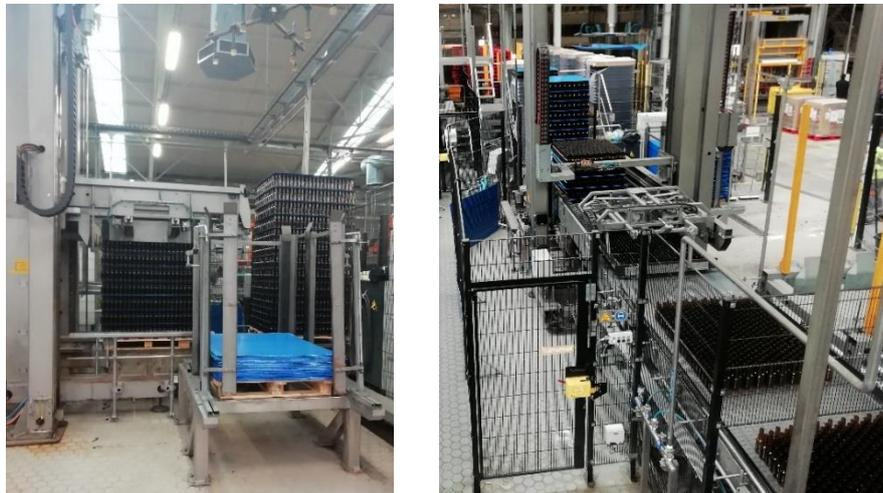
*Figura 22: Imagens ilustrativas da despaletizadora utilizada na linha 2.*
