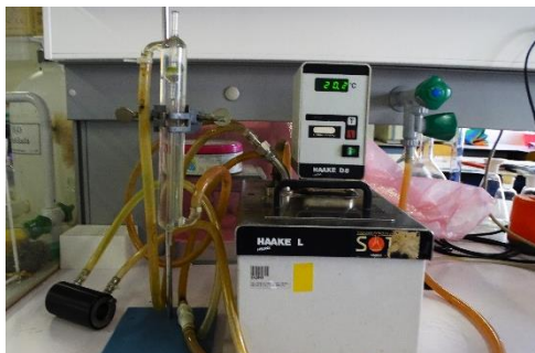
Figura 13 - Montagem experimental usada na determinação da viscosidade da pasta pelo método SCAN
