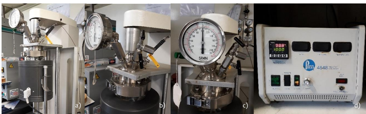
Figura 11 - Reator PARR da série 5100: a) Estrutura de suporte do reator com manta de aquecimento de inox; b) cabeça de agitador e válvulas de abertura e/ou fecho; c) medidor de pressão; d) controlador PID 4848.
