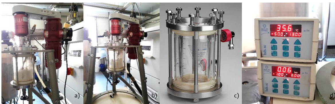
Figura 12 – Reator büchi AG: a) e b) montagem experimental do reator; c) vaso de vidro/metal do tipo 2; controladores de temperatura e pressão bds.sc.
