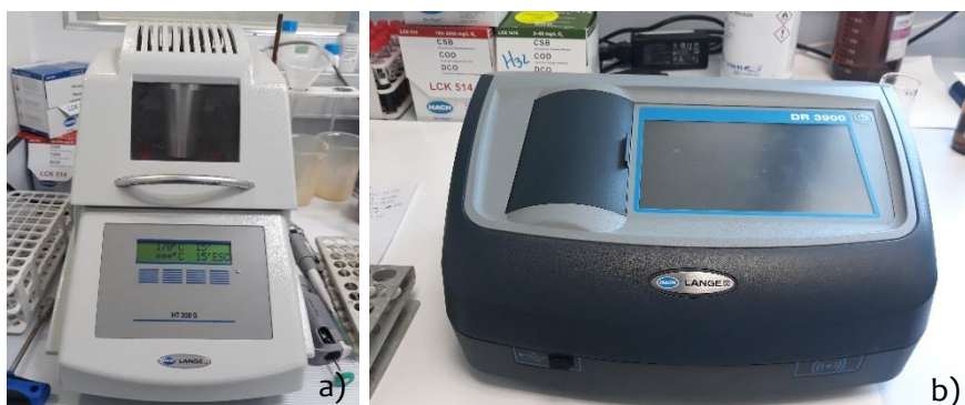
Figura 17 - Aparelhos utilizados na medição da Carência Química de Oxigénio: a) Termostato de elevada temperatura HT 200 S da HACH; b) Espectrofotómetro DR 3900 com tecnologia RFID da HACH
