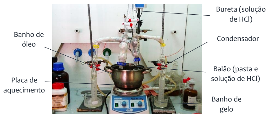
Figura 16 - Montagem experimental da determinação do teor de pentosanas
