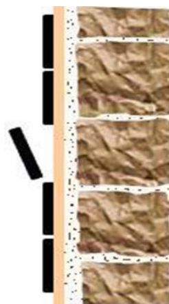
Figura 4 - Representação de fachada azulejada com problema de perda de aderência da argamassa de assentamento em um azulejo
