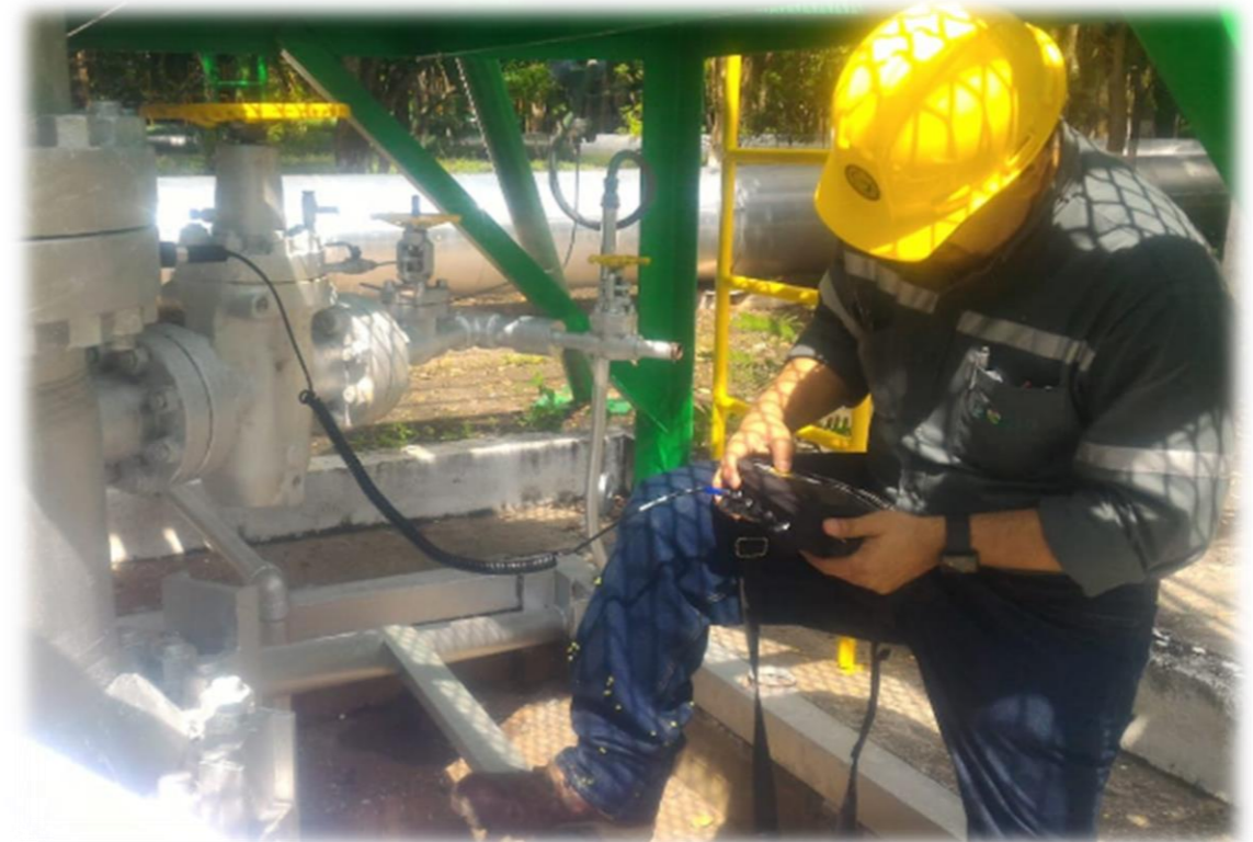
Vibraciones mecánicas en tubería de conducción. (medición por: Ing. Mario Herrera, CGAh).
