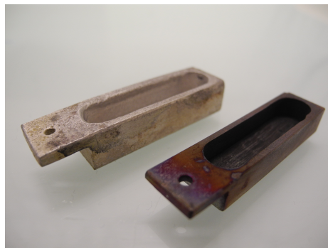
Abbildung 2.22. Passivierte Metallschiffchen aus Mg (hinten) und Ni (vorne). Interferenzfarben zeigen, dass die \text{NiF}_2 -Schicht, die zur Passivierung genügt nur wenige hundert Nanometer dick ist.
