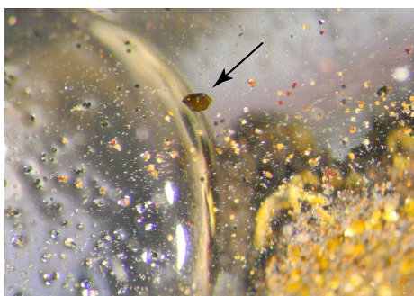
Abbildung 4.3. Makrofotografie eines Kristalls der Verbindung \mathbf{3U-4U-Br_{11}} (Pfeil) mit den ungefähren Abmessungen 0.5 \times 0.3 \times 0.2 mm neben zahlreichen grünen, roten und gelben Kristallen.
