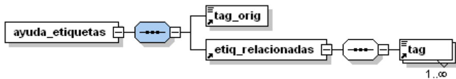
Ilustración 58: Estructura del xml de datos de interacción: elemento AyudaEtiquetas
