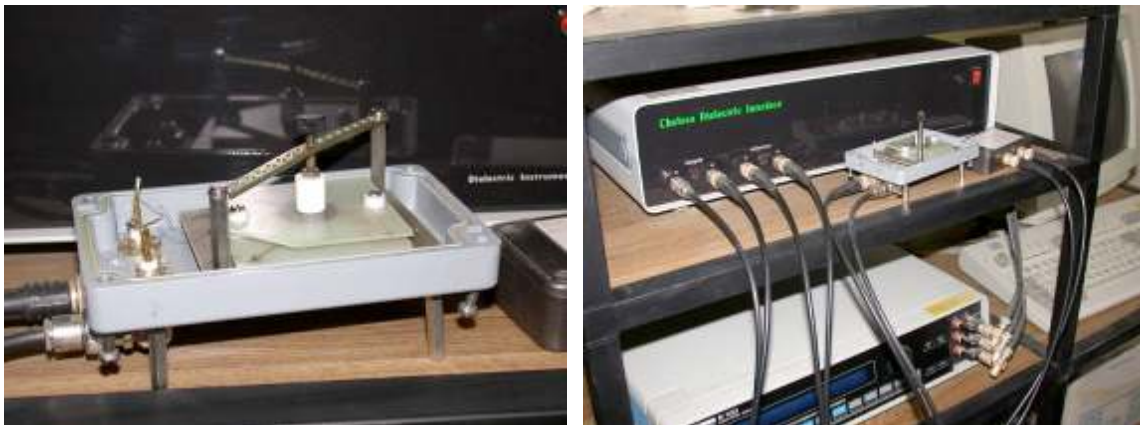
Figura 4.3: Portamuestras (izquierda) y equipo Chelsea Dielectric Interface conectado al portamuestras (derecha) utilizados para las medidas dieléctricas en el intervalo de frecuencias de 10^4 a 10^2 Hz.
