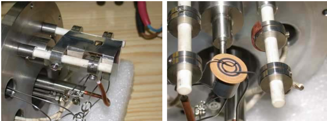
Figura 4.4: Interior de la cámara de medida de conductividad eléctrica en función de la temperatura (izquierda) y detalle de la muestra electrodada con oro sobre el horno portamuestras (derecha.)
