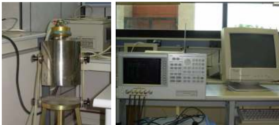
Figura 4.6: Horno portamuestras (izquierda) e impedancímetro (derecha) empleados para la realización de las medidas de espectroscopía de impedancia compleja.
