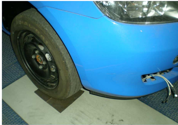
Figura 6.7: Fotografía del ensayo con papel de lija en el centro de la placa dinamométrica
