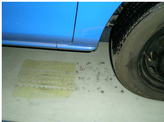
Figura 6.8: Fotografía del ensayo con lubricante en el centro de la placa dinamométrica
