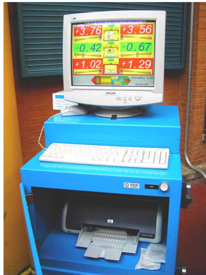
Figura 5.11: Ordenador que procesa la información de los elementos de medida de ángulos
