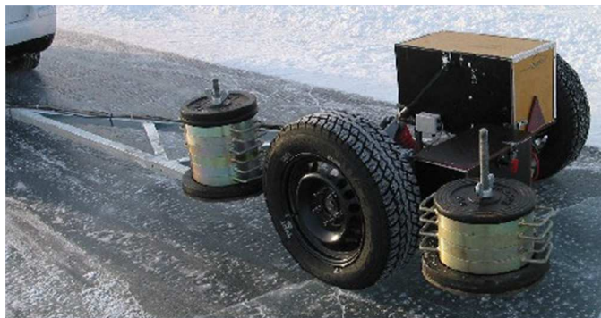
Figura 2.10: Remolque dinamométrico para el estudio de fricción en el contacto neumático suelo en dirección longitudinal
