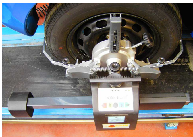
Figura 8.1: Fotografía de uno de los captadores del medidor del ángulo de dirección instalado en una rueda
