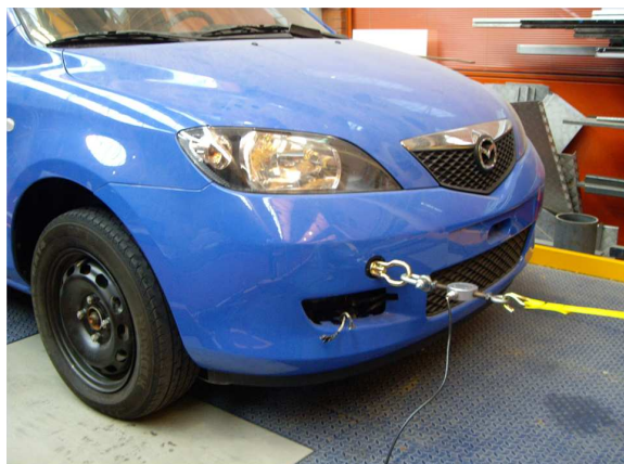
Figura 5.9: Fotografía del vehículo movido por el sistema de tracción con la célula de carga
