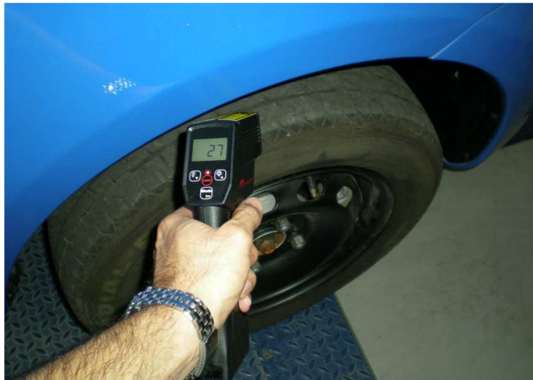
Figura 6.42: Fotografía del pirómetro empleado en los ensayos
