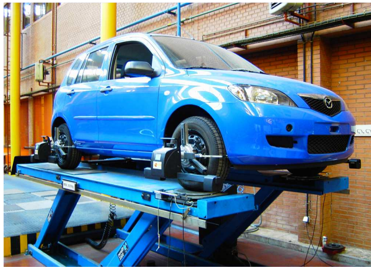
Figura 5.10: Vehículo en el elevador hidráulico, con los medidores de ángulos instalados
