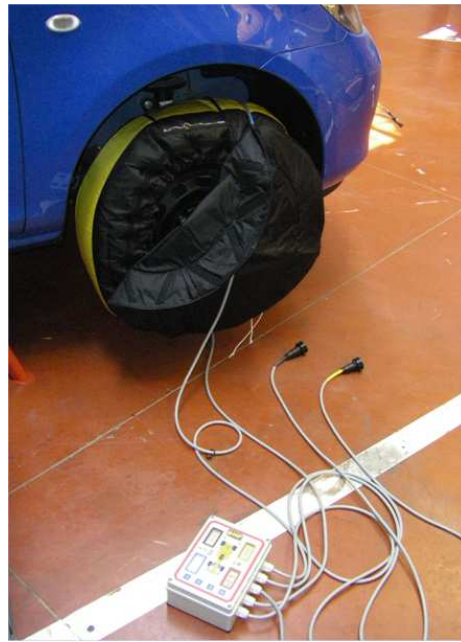
Figura 5.13: Imagen de la centralita y una de las mantas térmicas montada en el neumático
