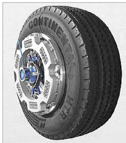
Figura 2.8: Llanta dinamométrica con sistema de transmisión de datos por telemetría
