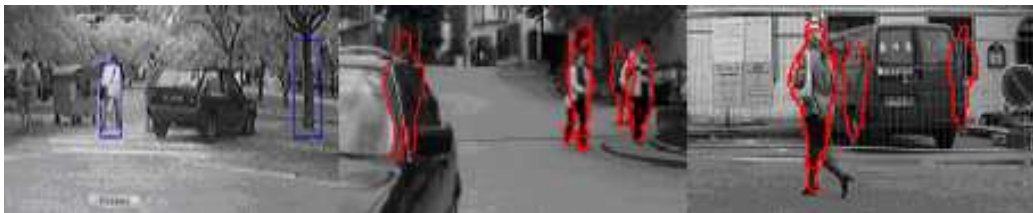
Figura 2.18: Ejemplo de errores de los modelos basados en la forma, del sistema GOLD de Parma [BBFS00].
