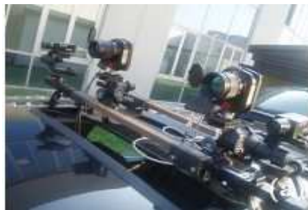
Figura 3.14: Sistema Tetravision. Las 4 cámaras utilizadas para la adquisición de imágenes se instalan en el techo del vehículo [BBF + 07a].
