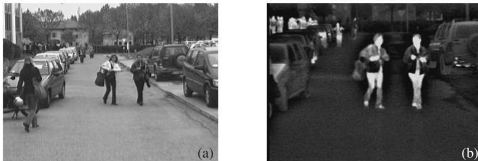
Figura 3.16: Ejemplo de un escenario típico tomado por el sistema Tetravision [BBF + 07b]; (a) imagen obtenida a partir del sistema estéreo visible e (b) infrarrojo.
