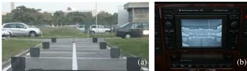
Figura 3.17: Sistema de calibración GOLD [BBG + 03] (a) Detalle de la rejilla de calibración y, (b) Ordenador que ejecuta la herramienta software para refinar la calibración.
