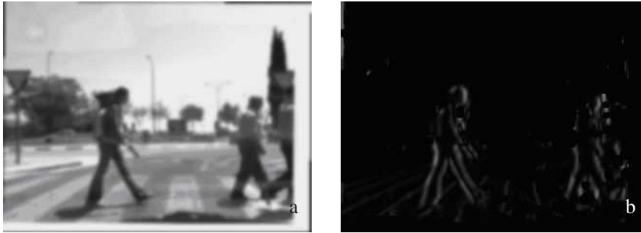
Figura 4.29: Pasos para la obtención del potencial debido a los bordes en la imagen ; (a) Efecto de la gaussiana aplicada a la imagen original y (b) Gradiente de los bordes obtenidos de la imagen suavizada y filtrada mediante las disparidades del mapa estéreo.
