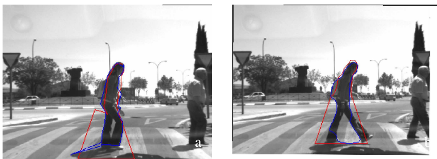
Figura 4.36: Ejemplos de los problemas típicos de los snakes . En rojo aparece la forma alcanzada en la secuencia anterior, y en azul, la deformación alcanzada en la secuencia actual a partir de la forma (roja) previa. Se puede apreciar como para la zona de las piernas se utiliza la forma triangular original; (a) Puede darse el caso de que algún punto quede atrapado en un mínimo local y (b) los snakes tienen dificultades para adaptarse a la parte interior de las piernas.
