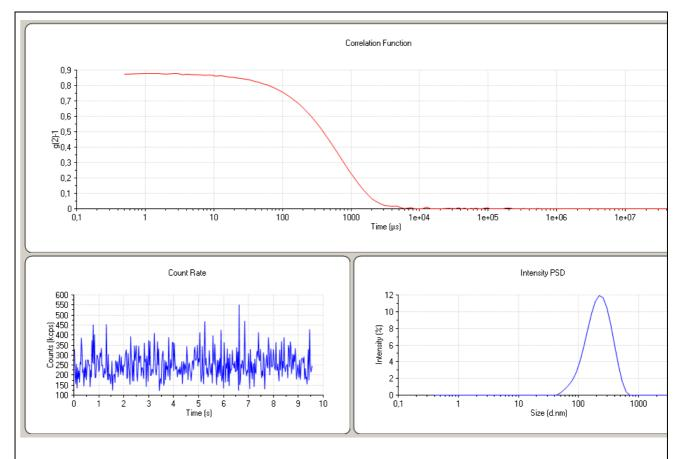
Fig. Medida de la distribución de tamaños de una dispersión de nanopartículas de SiO<sub>2</sub> en agua, después del tratamiento superficial.
