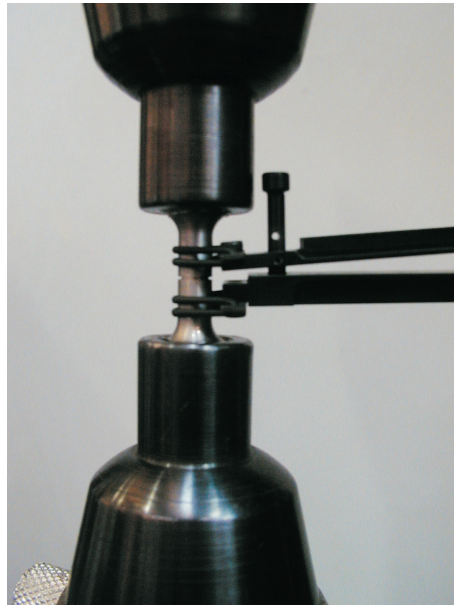
Figura 4.26: Montaje del extensómetro sobre una de las probetas ensayadas
