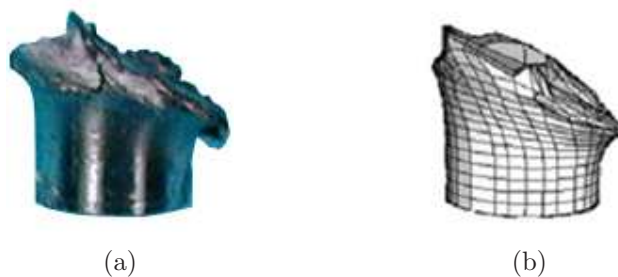
Figura 5.19: Geometría del proyectil tras el impacto. Caso n°4, (tabla 5.3). (a) resultado experimental, (b) simulación numérica.
