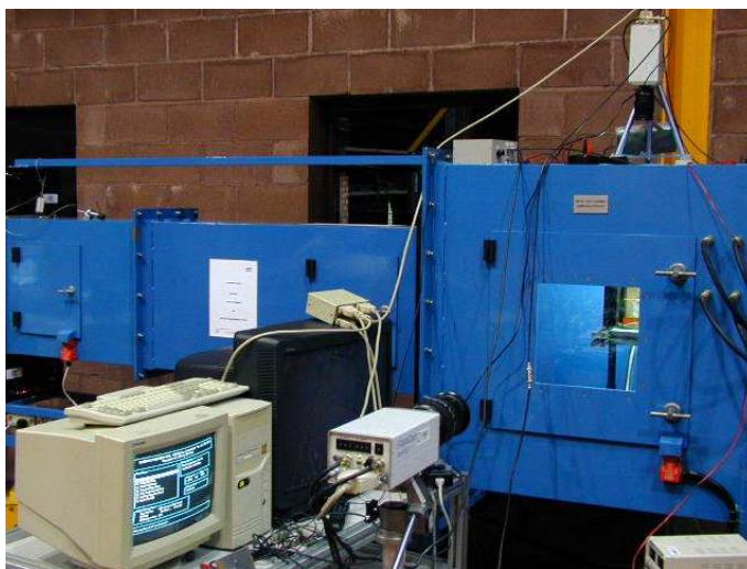
Figura 5.5: Sistema inicial de adquisición mediante fotografía ultrarrápida (cámaras Flash Cam PCO) empleado para la medición de la velocidad residual V_{res} .
