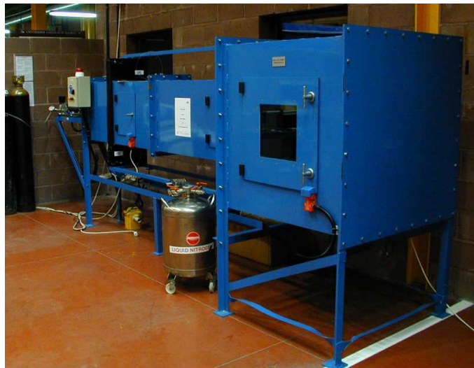
Figura 5.4: Cañón de gas, empleado para la impulsión de proyectiles, y cámara de impacto.
