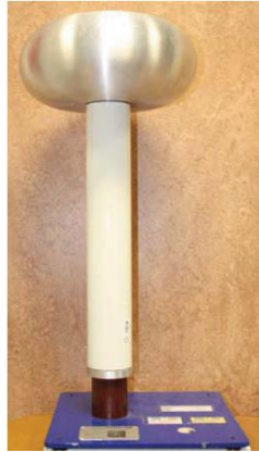
Fig. 10.2. Condensador de acoplamiento Haefely
