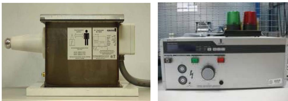
Fig. 10.1. a) Transformador de AT Schleich b) Módulo de control Schleich
