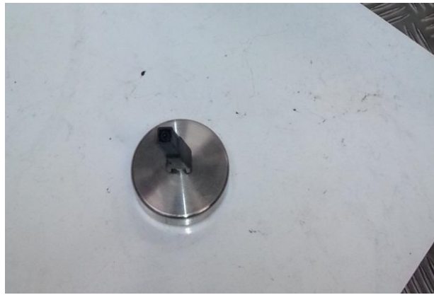
Fig. 5.2. Objeto de ensayo 2: electrodo sobre lámina de polietileno
