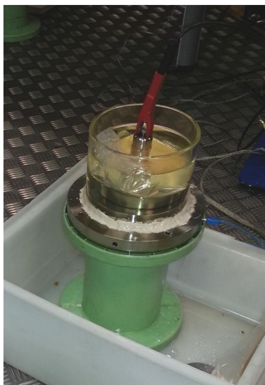
Fig. 5.1. Objeto de ensayo 1: papel aislante de ranura de transformador
