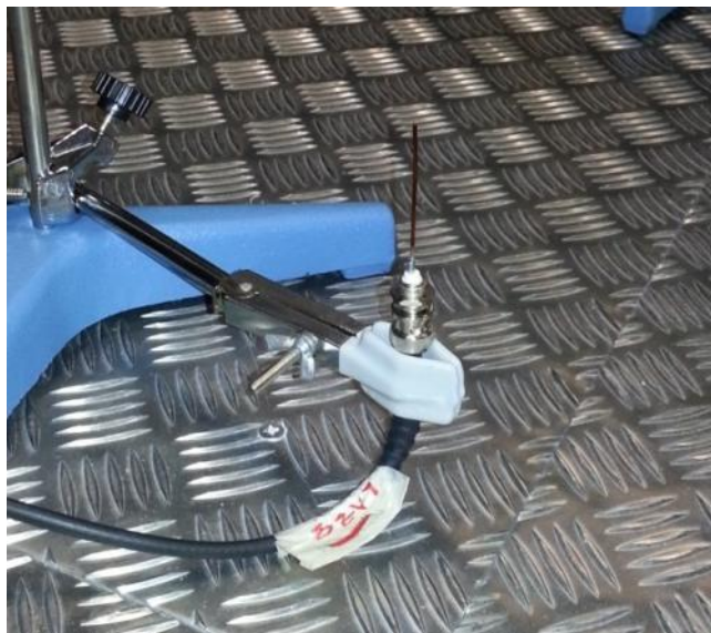
Fig. 3.17. Antena monopolo de 5 cm empleada en los ensayos de laboratorio
