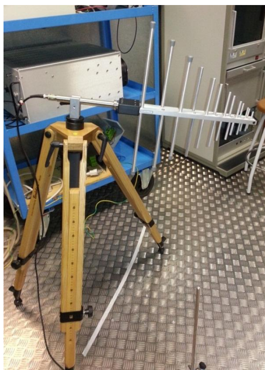
Fig. 3.19. Antena logarítmico-periódica UHALP 91088A en el laboratorio
