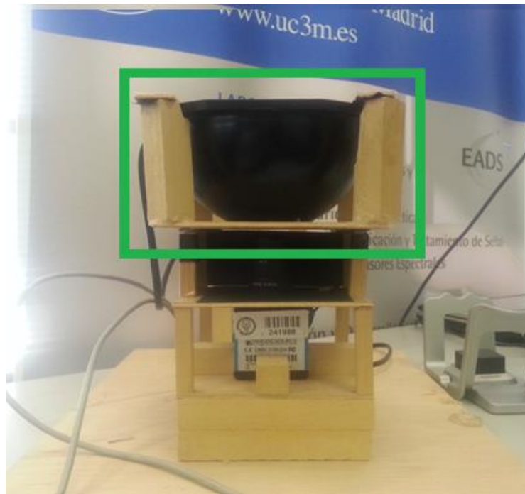
Fig. 11 – Cúpula de homogenización (perfil)
