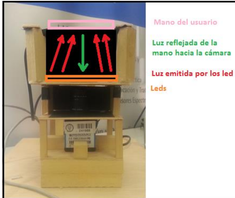
Fig. 35 – Funcionamiento alternativo sin bóveda
