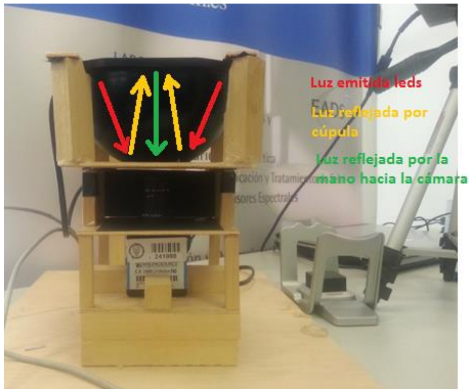
Fig. 10 – Funcionamiento de la bóveda de homogenización
