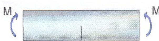
Figura 2.1: eje fisurado sometido a flexión.
