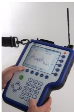
Fig. 8.1. Antena Diamond RH 789 conectada al PDS100 [Obtenida del manual del anexo]
