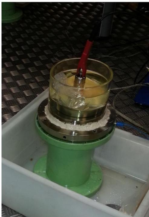
Fig. 4.5. Objeto ensayo DP internas: Papel aislante de ranura de transformador [33]
