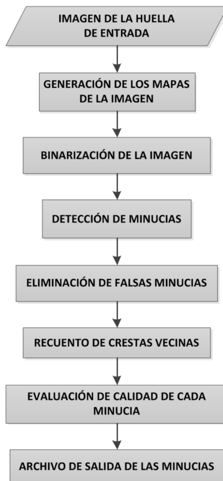
Figura 5: Diagrama de flujo del pre-procesado y extracción de minucias
