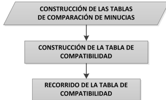
Figura 14: Diagrama de flujo del algoritmo BOZORTH3
