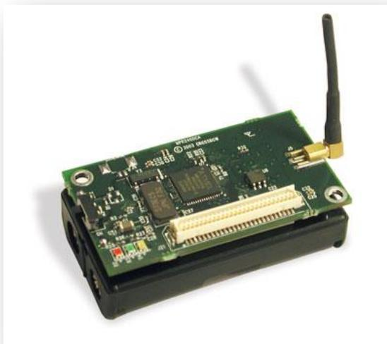
Figura 5: Nodo sensor MicaZ
