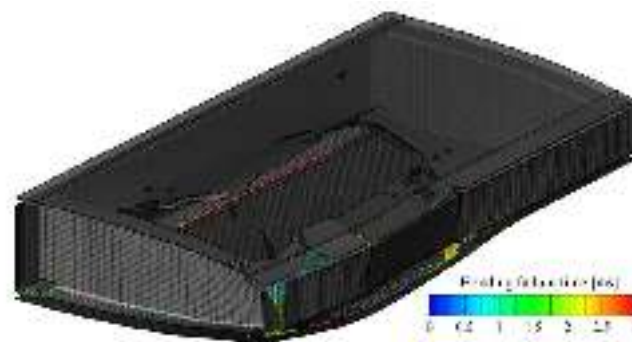
Figura 2.18: Daño en un tanque de combustible de material compuesto [78].
