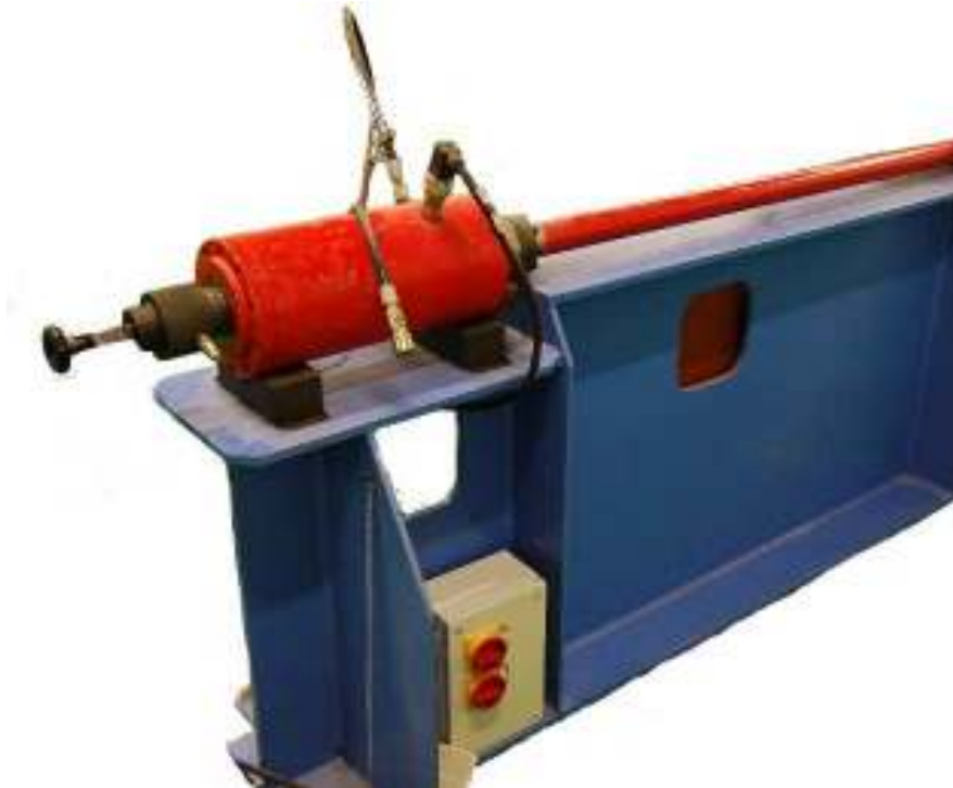
Figura 3.4: Sistema de impulsión.
