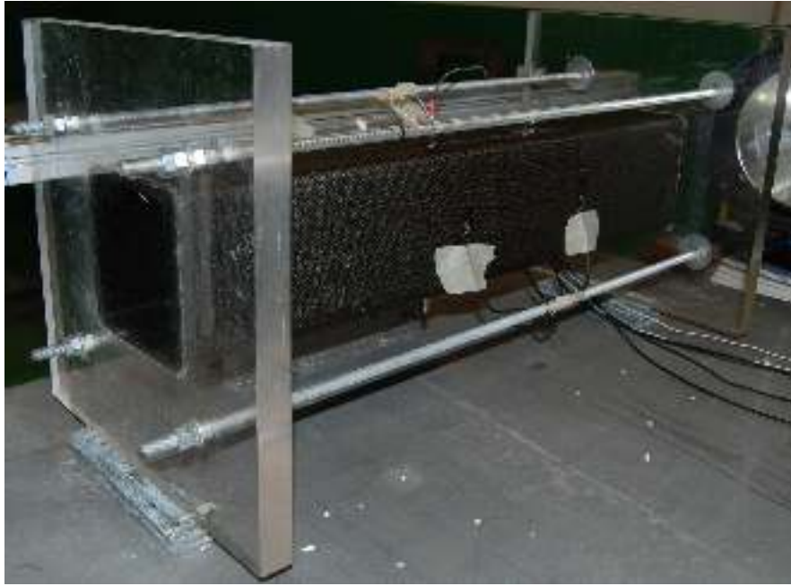
Figura 3.2: Detalle del montaje del tubo de material compuesto.
