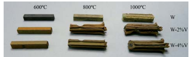
Figura 3. Imagen de las probetas oxidadas de los distintos materiales después de haber realizado los ensayos a 600 , 800 y 1000 \text{ }^\circ\text{C} respectivamente.
