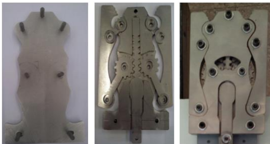
Figura 6.3 Montaje del sistema de agarre: (a) parte inferior, (b) intermedia y (c) parte superior.
