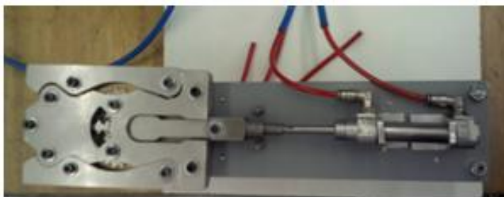
Figura 6.14 Fijación de las pinzas y el cilindro de doble efecto en la placa.
