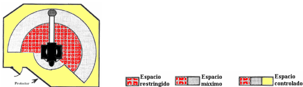
Figura 2.34 Ejemplo de clasificación del espacio de trabajo de un robot industrial [8]
