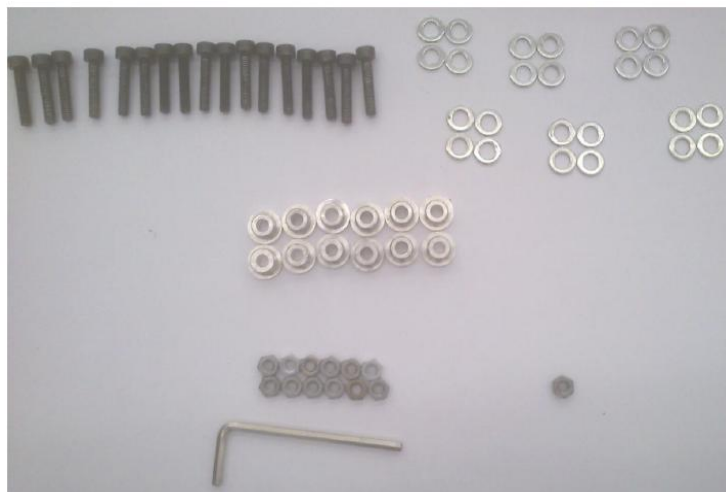
Figura 3.7 Tornillos, arandelas, tuercas y cojinetes empleados en el conjunto.
