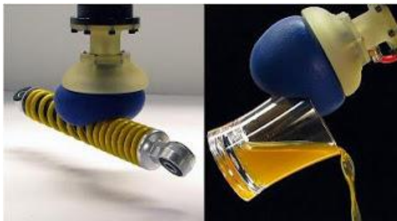
Figura 2.14 Globo de látex relleno de café molido y sistema de vacío [4].
