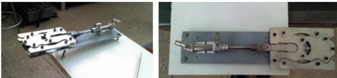
Figura 6.11 Montaje de las pinzas y el actuador.
