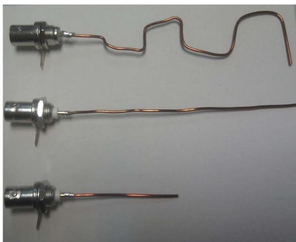
Figura 3.13: Antenas monopolo, de arriba a abajo: zigzag 10 cm, 10 cm y 5 cm.
