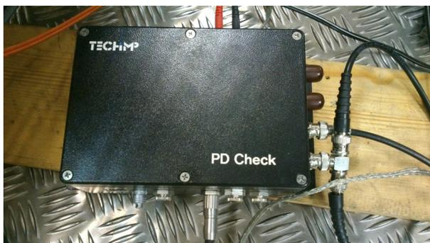
Figura B.9: Medidor de descargas parciales *PDCheck* de *Techimp*.
