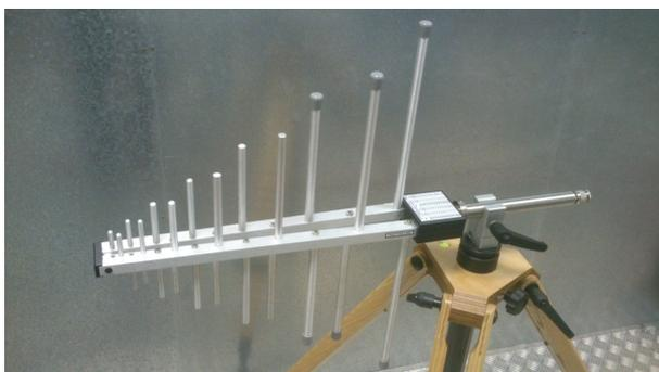
Figura B.11: Antena logarítmico-periódica UHALP 9108A.
