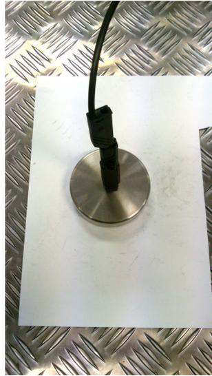
Figura 6.3: Lámina de polietileno sobre la que se generan DPs superficiales.
