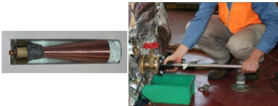
Figura 4.7: Antena de bocina e introducción en la válvula de drenaje de un tanque de transformador, (López-Roldán et al., 2008).
