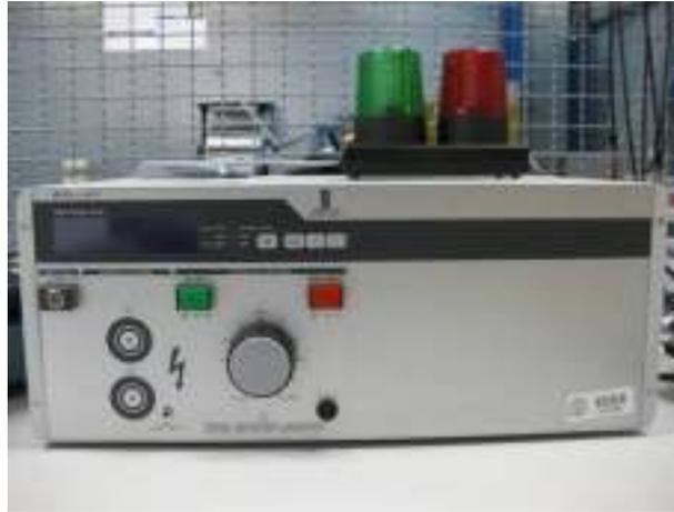
Figura B.2: Módulo de control (GLP1-e HV).
