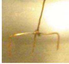
Figura 6.8: Objeto de ensayo para generar DPs corona en cable de cobre.
