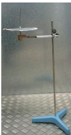
Figura 3.16: Monopolo de 10 cm con plano de tierra en trípode.
