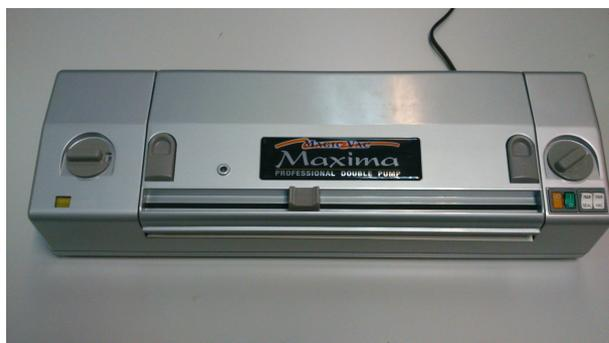
Figura B.12: Envasadora al vacío de  $50 \times 16 \times 10$  cm, peso 4 kg, aspiración 13 l/min, barra de soldadura de 30 cm y depresión de hasta 932 mbar.
