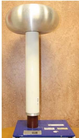
Figura B.3: Condensador de acoplamiento.
