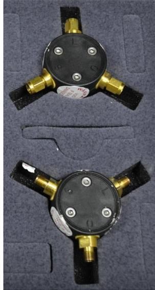
Figura 3.6: Conjunto de calibración de un analizador de redes.
