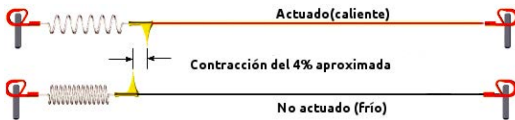
Figura 5.1: Elongación en una SMA. Cortesía de autosplice® [106].
