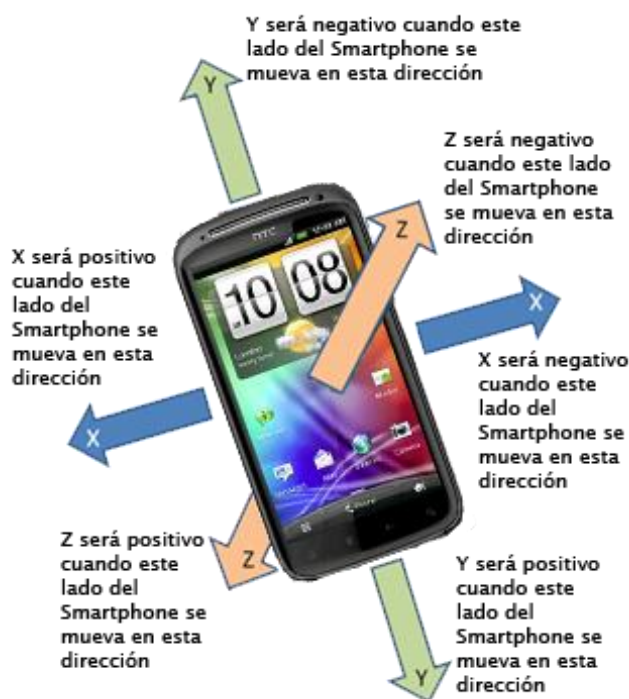
Fig. 29. Fuerzas detectadas por un acelerómetro
