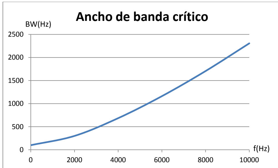
Figura 25: Ancho de banda crítico como función de la frecuencia central.
