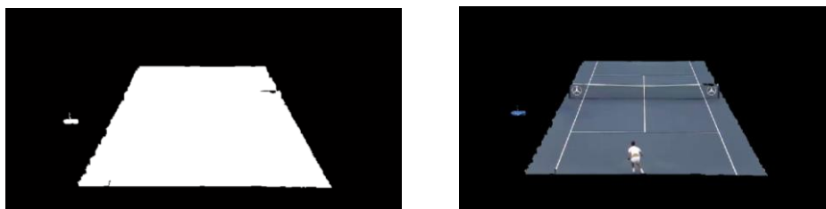
Figura XIII. Ejemplo del error producido al coincidir un elemento externo del campo con la línea añadida
