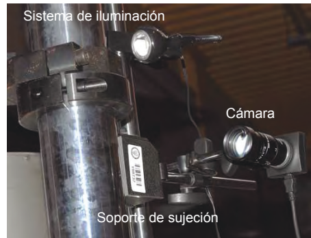
Figura 4.6: Cámara fotográfica empleada para la adquisición de datos desplazamiento y rotación
