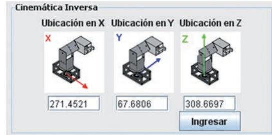
La introducción de datos se puede realizar indistintamente en cualquiera de los dos paneles. Si la introducción de datos se hace en el panel de la cinemática directa, los valores del panel de la cinemática inversa se actualizan automáticamente, y de igual manera, si se introducen los datos en el panel de la cinemática inversa, se actualizan automáticamente en el panel de la cinemática directa.
