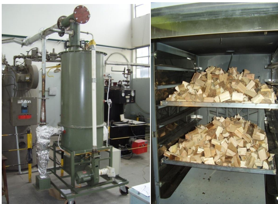
Figura 3.19 Operação e combustível do Gaseificador downdraft de biomassa de 30 kW (Coronado, 2007).
