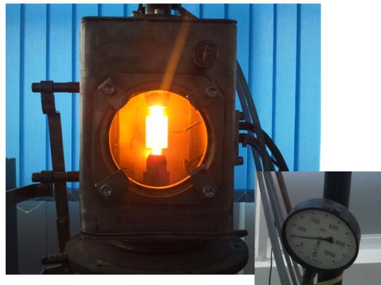
Figure 3.1 Cámara de SPS durante la sinterización y manómetro a 100 bares de presión.
