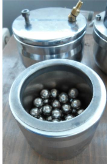
Figura 2.2 Bolas de molienda y su acción en la molienda tipo planetaria
