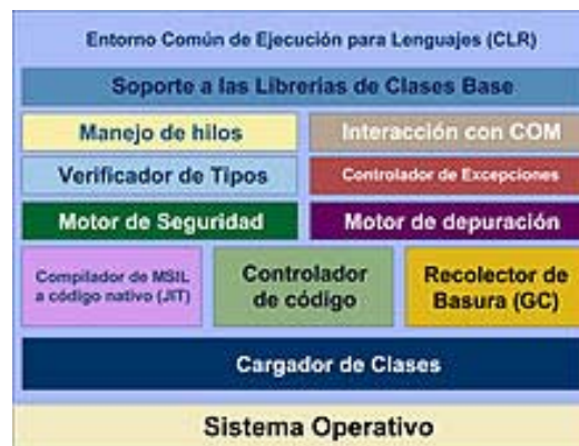
Estructura interna del entorno de ejecución en lenguaje común. Fuente: [42]
