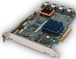
Ilustración 2: Adaptec 31605 RAID Controller
