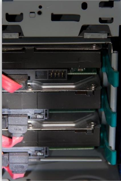
Ilustración 17: conexión SATA en arquitectura DAS.
