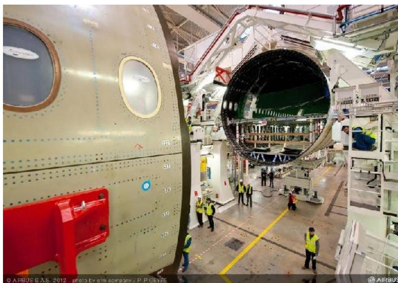
Figura 25. Ensamblado de secciones del A-350. Fuente: Airbus
