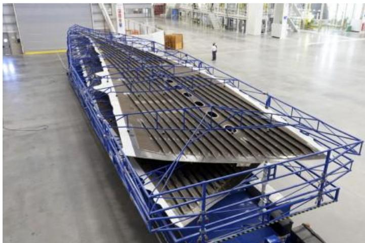
Figura 35. Parte inferior externa del ala. Fuente: Airbus
