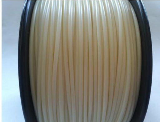
ILUSTRACIÓN 34. ABS NATURAL EN BOBINA
