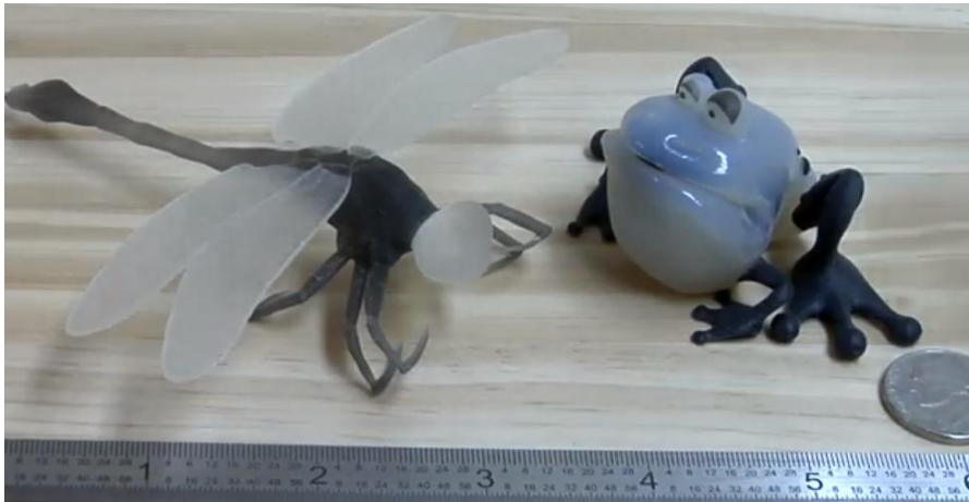
ILUSTRACIÓN 3. PIEZAS FABRICADAS MEDIANTE MATERIAL JETTING
