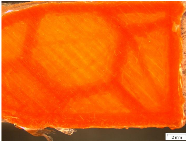
ILUSTRACIÓN 141. DETALLE PROBETA MALLADO HONEYCOMB 10% SIN TESTEAR
