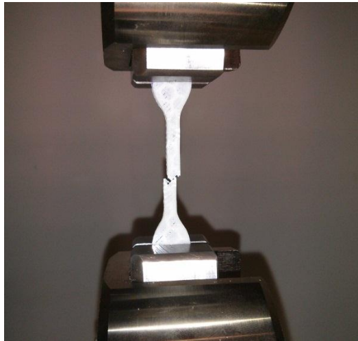
ILUSTRACIÓN 58. DETALLE RESULTADO FINAL DE UN ENSAYO DE TRACCIÓN
