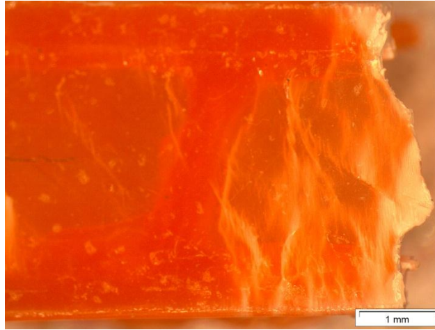
ILUSTRACIÓN 140. CORTE PROBETA ABS ROJO MALLADO HONEY 20%
