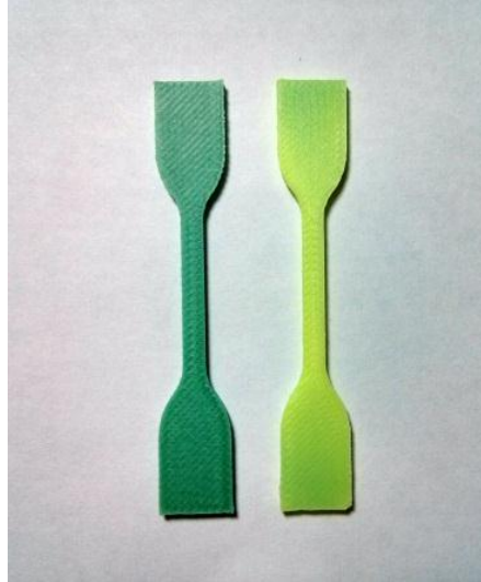
ILUSTRACIÓN 36. ABS CAMBIO DE COLOR CON LA TEMPERATURA
