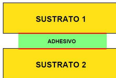
Figura 11: Esquema básico de una unión adhesiva
