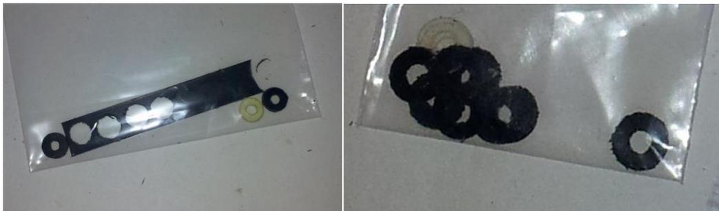
Figura 14 Muestras obtenidas del *composite* US-CNTs/epoxi tras el curado (izquierda) y tras el mecanizado (derecha)
