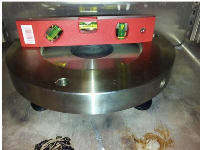
**Figura 12** Molde para la infiltración y curado de los *buckypapers* con epoxi
