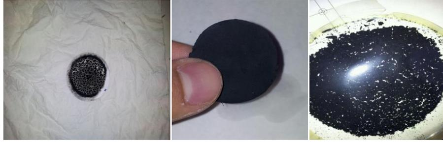
**Figura 11** Resultado de preparación de *buckypapers*. De izquierda a derecha: *buckypaper* de CNTs tras el filtrado, *buckypaper* de CNx tras el filtrado y *buckypaper* de CNx infiltrado con epoxi
