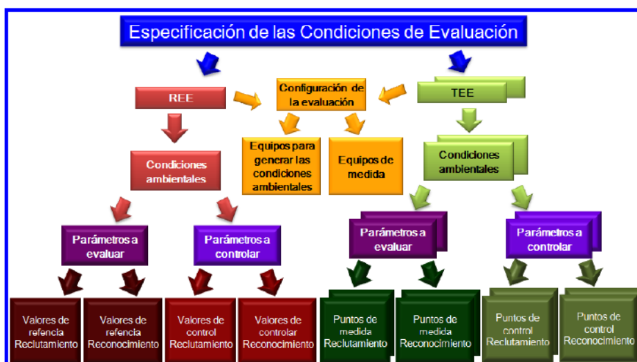
Fig. 2 Diagrama general para la especificación de las condiciones de evaluación conforme a la norma ISO/IEC DIS 29197.
