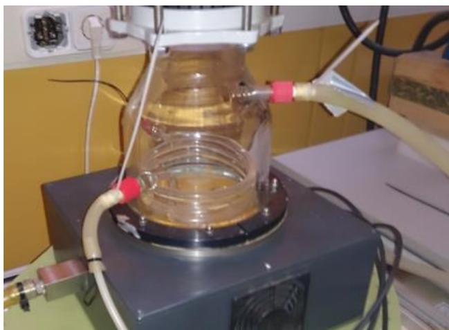
Figura 21: Atomizador vacío, donde se aprecia el circuito de refrigeración
