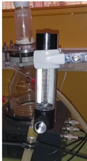
Figura 24: Detalle del medidor de caudal de argón
