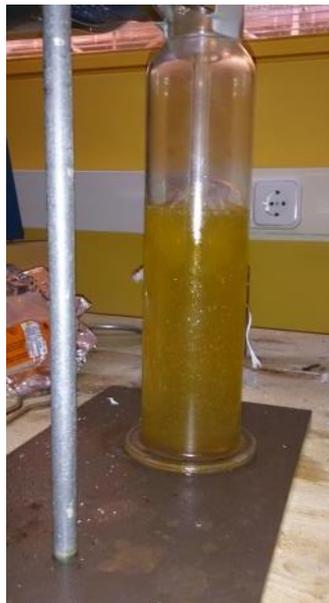
Figura 27: Detalle del vaso que contiene la silicona, burbujeando debido al paso de fluido
