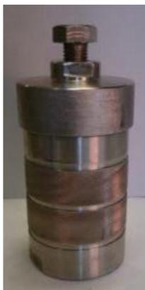
Figura 28: Contenedor hidrotérmico
