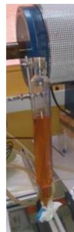
Figura 22: Columna de cristal para el llenado del vaso
