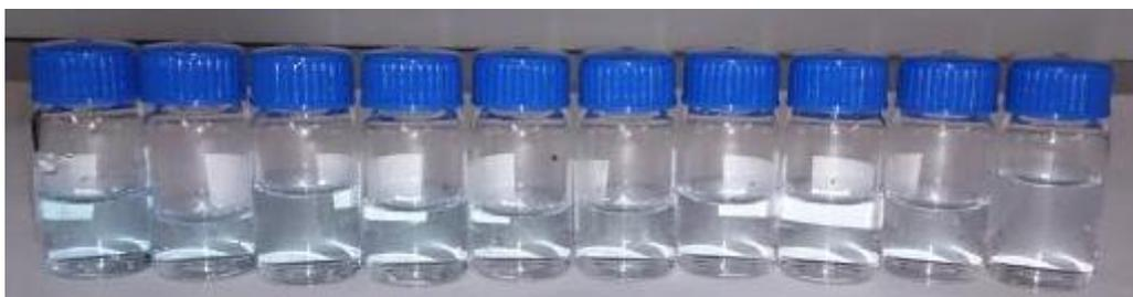
**Figura 102: Muestras obtenidas tras exposición de 2,5 horas en lámpara UV**
