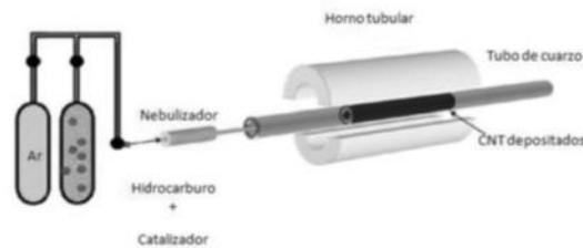
Figura 9: Esquema de las instalaciones del método de spray pirolisis
