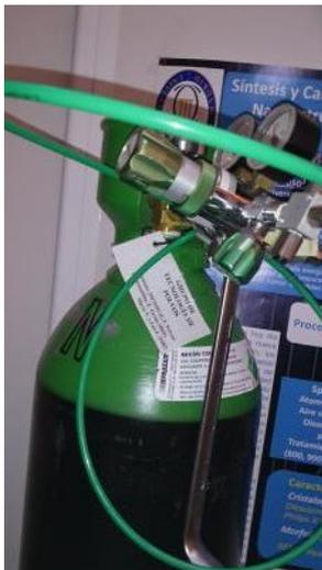
Figura 23: Detalle del depósito de Argón con la válvula reguladora
