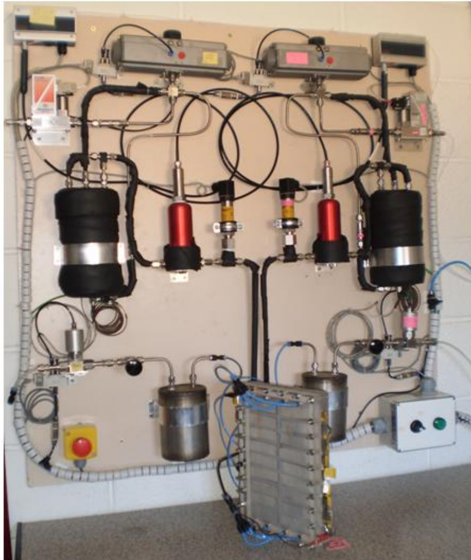
Figura 4.38. Prototipo de sistema integral de medición y control de variables de estado de una pila: versión educativa.
