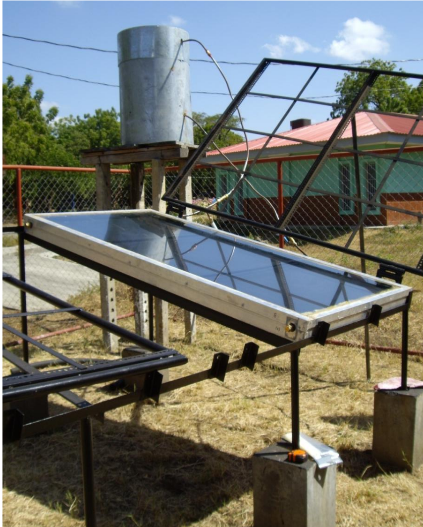
Figura 3.52: Circuito cerrado con un colector.
