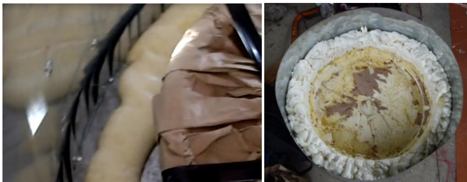
Figuras 3.45.a y 3.45.b: Polietileno expandiéndose y forma final del Polietileno expandido.
