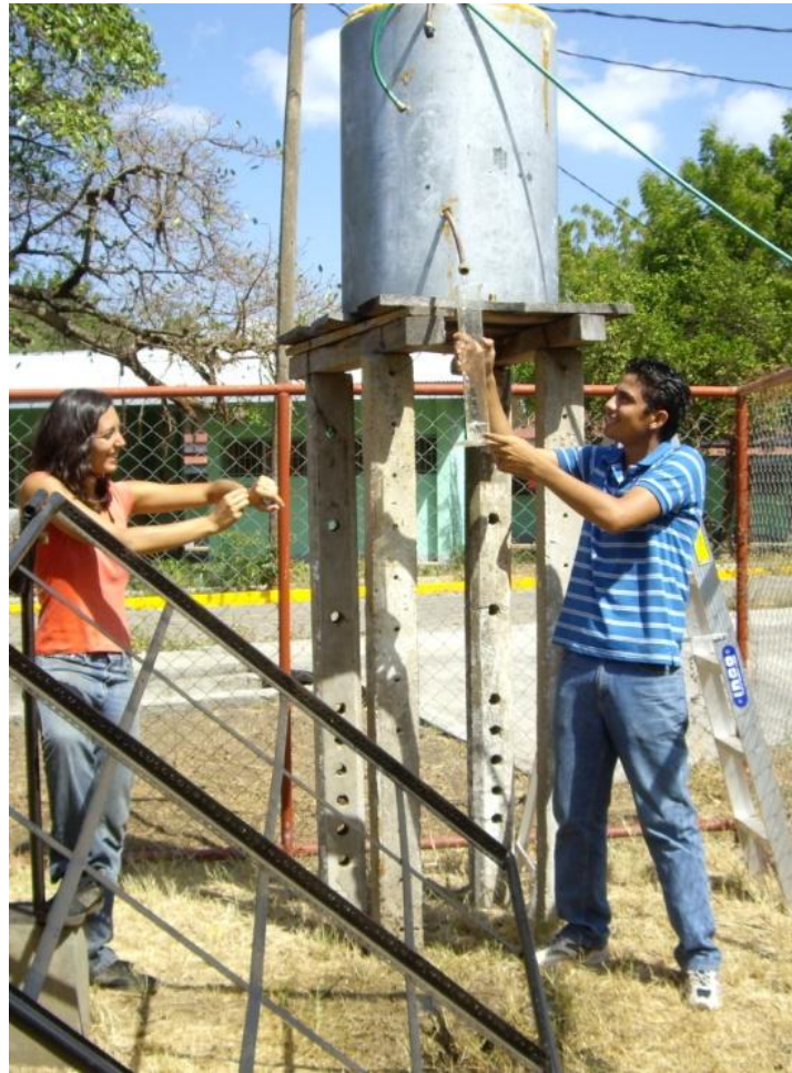
Figura 3.40: Tomando el tiempo y volumen del tubo de salida del tanque.
