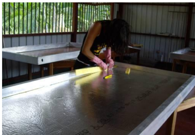
Figura 2.26: Poniendo la fibra de vidrio en la caja.
