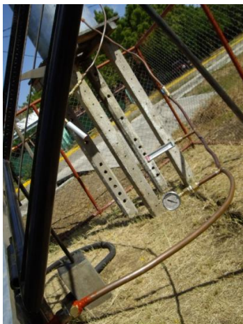
Figuras 3.51.a y 3.51.b: Conexión de entrada y salida de agua del tanque con el colector.
