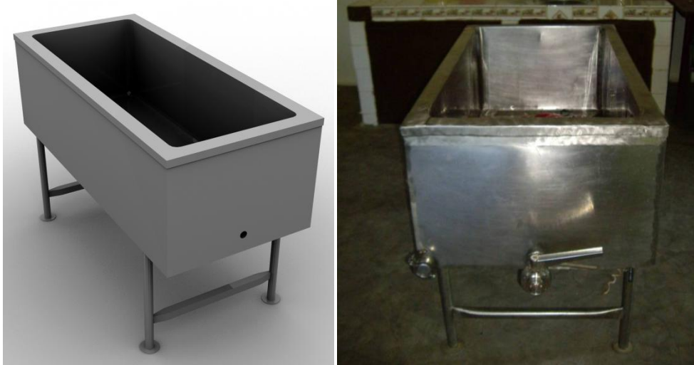
Figuras 2.46.a y 2.46.b: Render y foto del depósito de leche pasteurizada.
