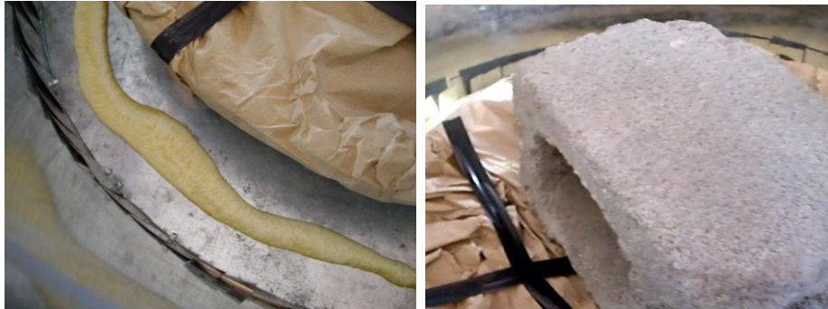
Figuras 3.44.a y 3.44.b: Se vierte el polietileno expandido sobre la chapa de zinc y un peso sobre la tapa.
