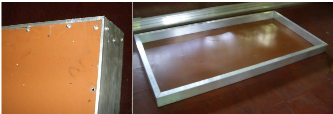
Figuras 2.21.a y 2.21.b: Remaches que unen la caja con la lámina de zinc y resultado final.
