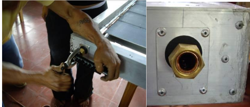
Figuras 2.32.a y 2.32.b: Avellanando el tubo. Tubo avellanado.
