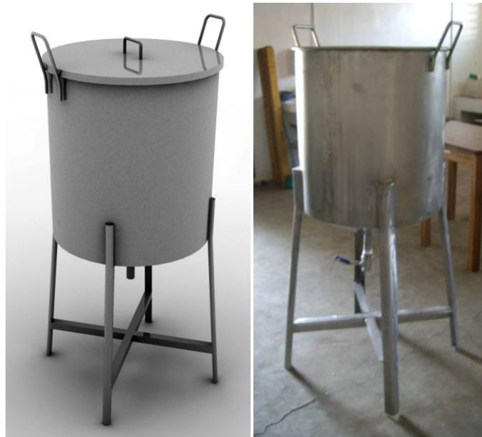
Figuras 2.44.a y 2.44.b: Render y foto del depósito de leche sin pasteurizar.
