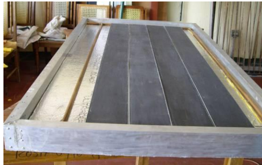
Figura 2.30: Parrilla de cobre, fibra de vidrio y placas de aluminio en la caja.
