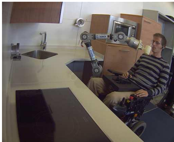
Figura 1.2: El robot ASIBOT anclado a la silla de ruedas en el entorno de pruebas de la cocina para robots asistenciales de la UC3M. Se pueden observar dos estaciones de anclaje situadas en las paredes.
