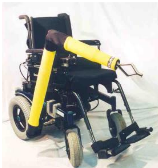
Figura 2.4: a) Manipulador robótico Asistencial Manus ARM montado sobre silla de ruedas. b) Plataforma robótica asistencial denominada Raptor ARM.
