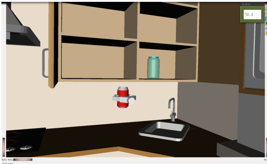
Figura 3.14: Visor de simulación en OpenRAVE que muestra el entorno virtual de experimentación: cocina, mano robótica y objetivo.
