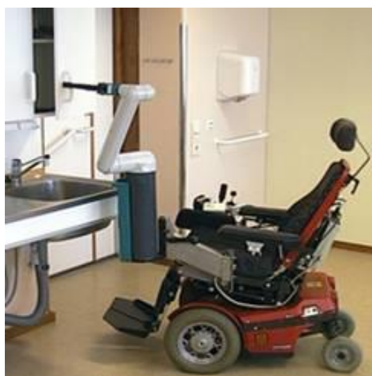
Figura 2.4: a) Manipulador robótico Asistencial Manus ARM montado sobre silla de ruedas. b) Plataforma robótica asistencial denominada Raptor ARM.
