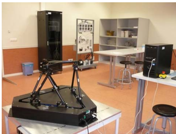
Figura 5. Laboratorio de Navegación y Mecánica de Vuelo. En primer plano puede verse el hexápodo y al fondo el sistema de instrumentación de cabina.
