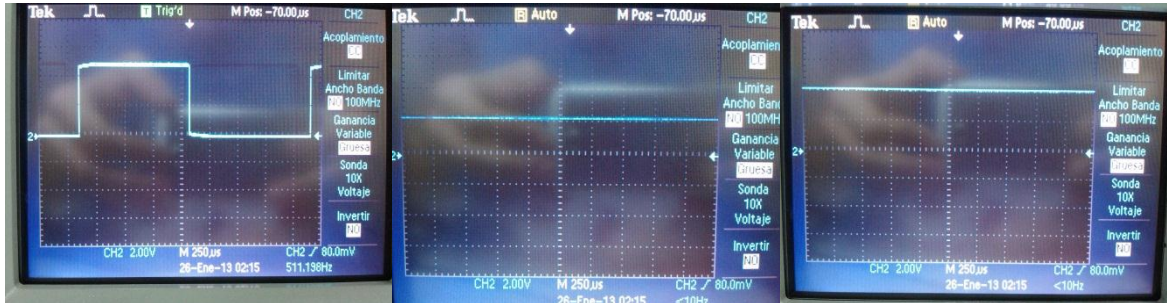
Figura 40 Acondicionamiento salida PWM -> Salida Filtro -> Amplificación: Señal de referencia de la maqueta
