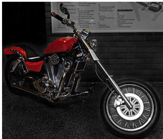
Figura 9. Una Suzuki Intruder Chopper, se observa el claro alargamiento de la horquilla.
