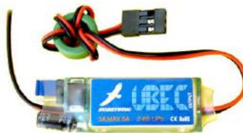
Ilustración 15. UBEC regulador de voltaje
