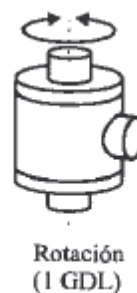
Ilustración 23. Movimiento de rotación de las articulaciones
