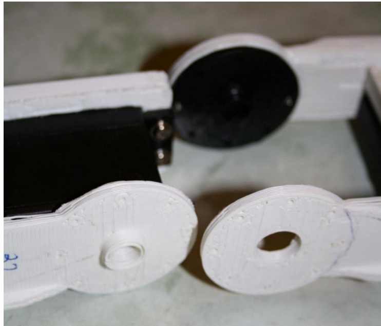
Ilustración 22. Imagen del sistema de unión entre dos de los eslabones.
