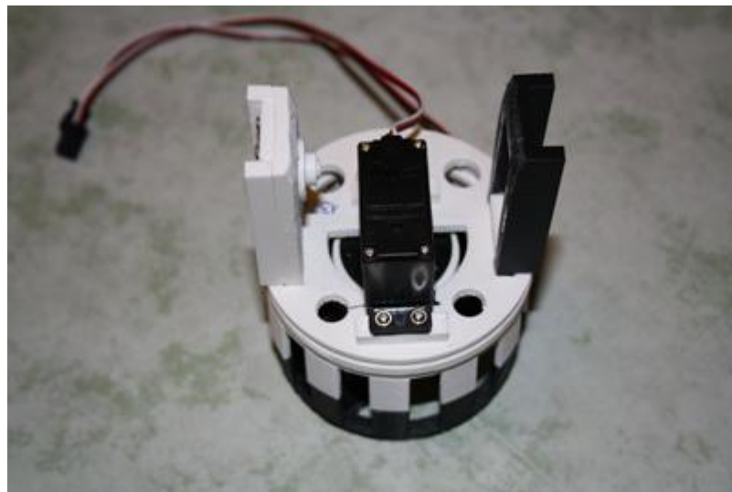
Ilustración 25. Servomotor superior de la base del robot.
