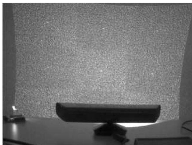
Figura 15: Proyección infrarroja con la cámara Kinect.
