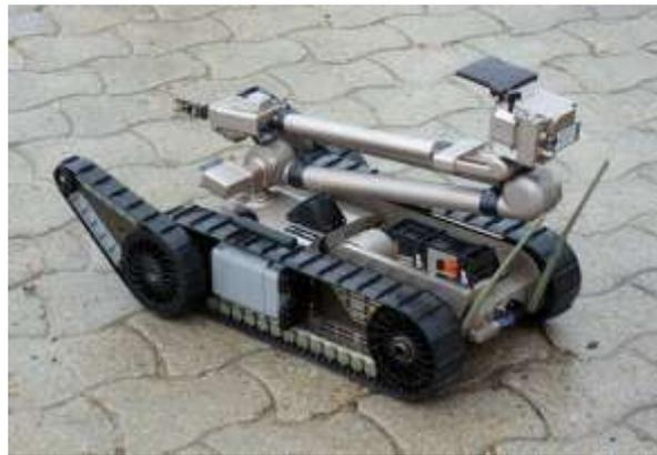
Figura 1: Robot Packbot desactivador de bombas.
