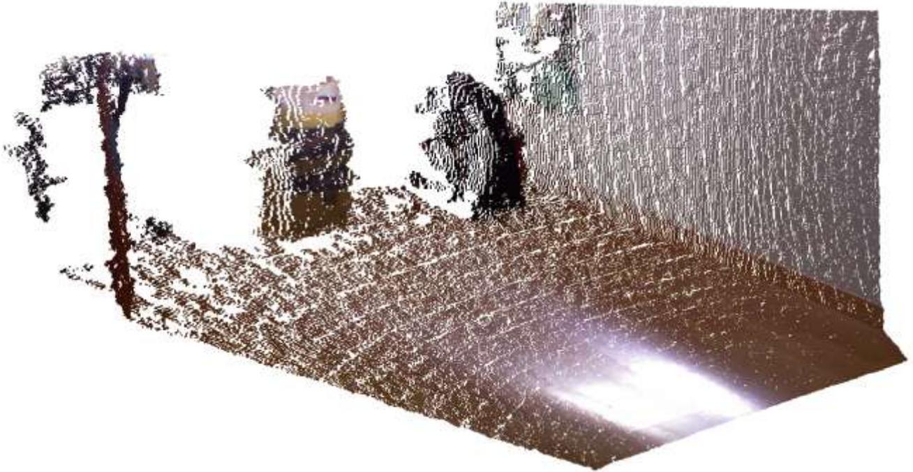
**Figura 32: Imagen segmentada en altura y profundidad.**
