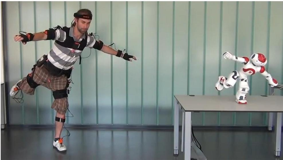
FIGURA 2-24: NAO IMITANDO LA POSICIÓN DEL CUERPO DEL OPERADOR
