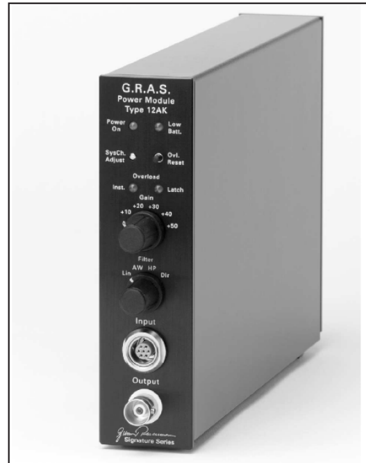
Fig. 1 Power Module Type 12AK
