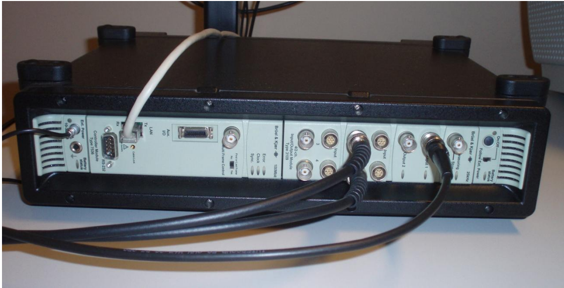
Figura 36: Unidad portátil de adquisición de datos 3560-C PULSE de Brüel & Kjaer
