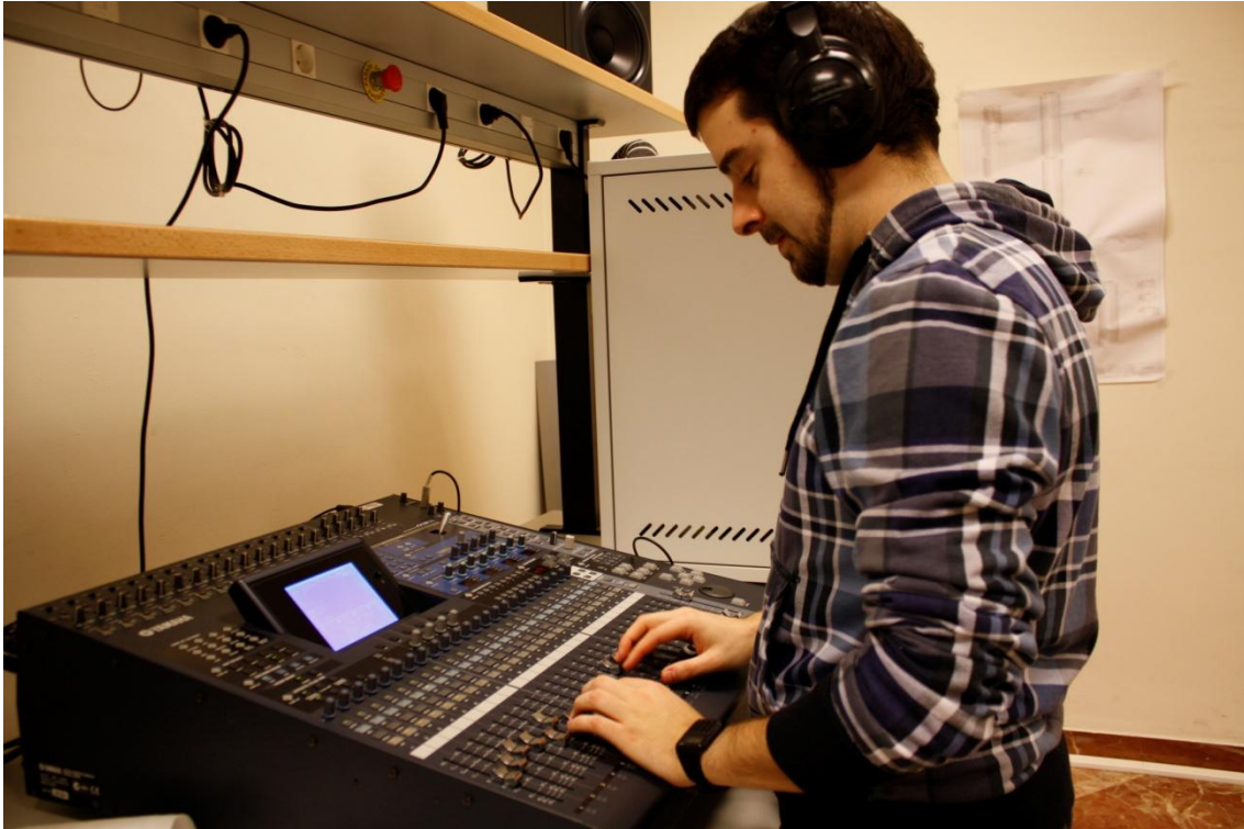
Figura 38: Posición de control en el laboratorio de acústica. A través de los auriculares o escuchas se recibe la monitorización del músico, con el que es posible comunicarse apretando el botón de Talkback de la mesa.
